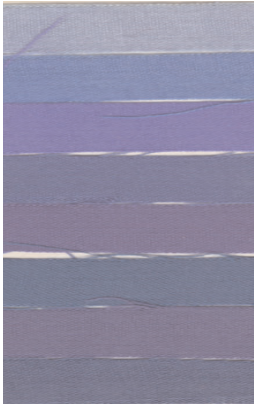
Abb. Foto der Wollskala Acht genormte, mit blauen Farbstoffen unterschiedlicher Lichteichtheit eingefärbte Teststreifen
