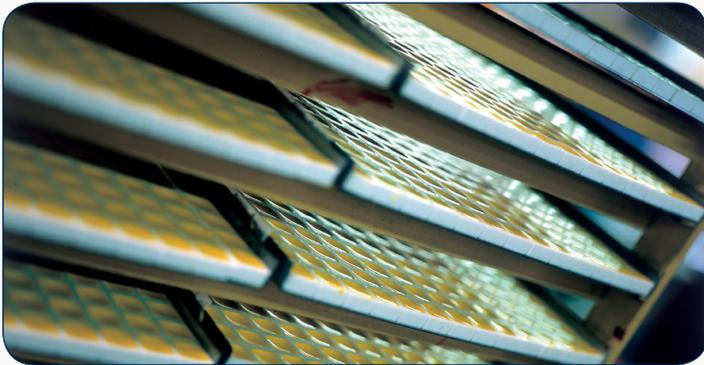
Die Farben werden im ersten Arbeitsgang flüssig vergossen und kommen dann, je nach Farbton, für mehrere Wochen in einen Trockenraum. Anschließend erhalten sie den zweiten Guß, dem eine weitere mehrwöchige Trockenphase folgt. Dieses Verfahren wiederholen wir vier Mal; insgesamt dauert die Produktionszeit 3-5 Monate. Denn so überragend wie die Qualität der Farbe ist, so außergewöhnlich muß eben auch ihre Produktion sein. Daher produziert Schmincke im Flüssigießverfahren.
